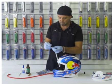
②まず「1」のプライマーでANTMANベーストリムズの溝の中(ヘルメットとANTMAN製品が当たる面)を何度か往復させながらプライマーを塗り付けます。プライマーはペンタイプなので作業はしやすいです。
