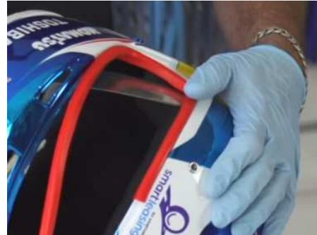
⑥アイポートは内装のスポンジが傍にあるため、縁ゴムが装着しにくい箇所は「ヘラ」を使ってゴム部分を装着していきます。
