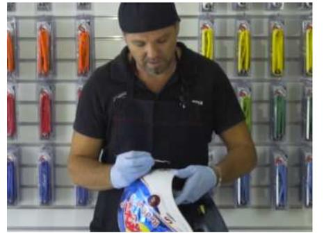
⑮後頭部の切れ目の部分から接着していきます。もう片方の切れ目はまだ接着しないでください。
