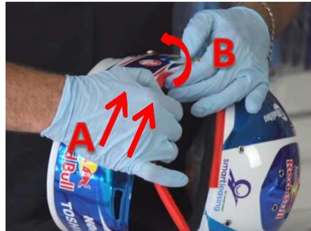
⑨接着剤を塗り終わったら「A」の手で縁ゴムをカーブ部分に押し上げながら「B」の手で接着部分を矢印の方向へ押し上げながら接着を待ちます。時間の経過により縁ゴムがカーブ部分から剥がれるのを防ぐためです。
