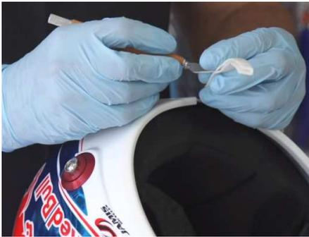
⑬人差し指と中指でゴムを挟み、親指と薬指でゴムを挟み間のスペースをクラフトナイフでカットします。このとき3~4cmくらい余裕を残してカットしてください。※カット作業は十分気を付けて行ってください。
