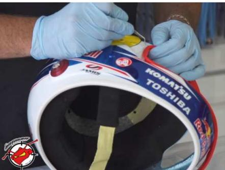
⑦接着剤を塗ります。まずはカーブの部分から塗ります。塗った後は親指で押し上げるようにヘルメットと縁ゴムを密着させ接着してください。
